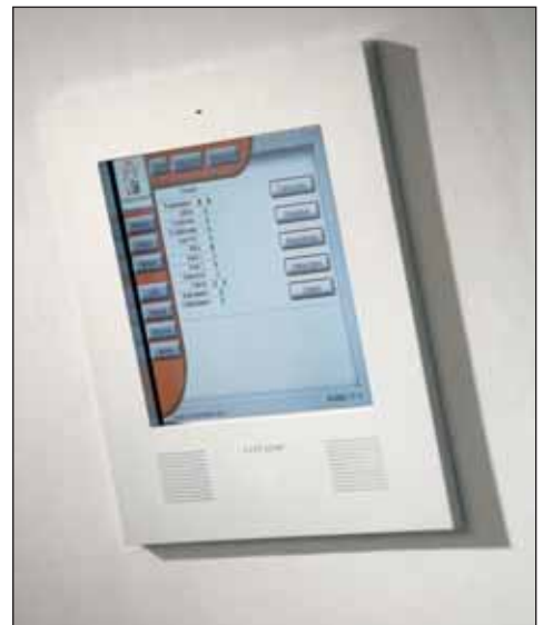
Bild 4. Über das zentrale Master-Panel werden alle Funktionen bedient. Weitere raumbezogene Panels dienen zur individuellen Bedienung.
